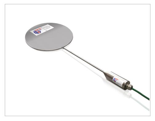
Датчик давления грунта используется для разделённых небольшой полостью, мониторинга суммарного давления между конструкцией и грунтом.
