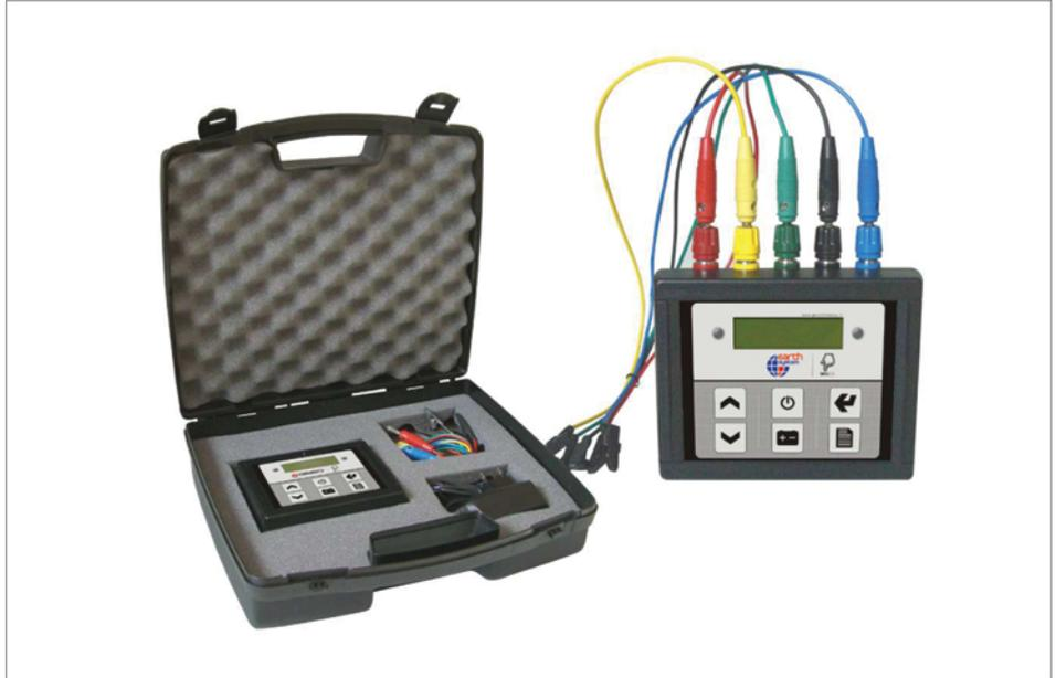
MULTIGEO 01 это многофункциональный даталоггер, предназначенный для считываний вручную показателей всех типов электрических и струнных датчиков. Помимо своих основных функций замеров вручную MULTIGEO может также использоваться при инсталляции, контроле и обслуживании датчиков. Работает от аккумуляторных батарей 12V. Подсвечивающийся дисплей отображает: считываемые устройством данные, уровень заряда батареи и схему
